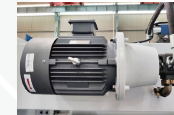
SIEMENS Main Motor
